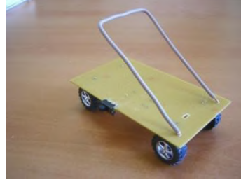
Resim 11 Güneş pillerinin üzerine yerleştirileceği çerçeve. (Uzal, Kişisel Albüm, 2009)
