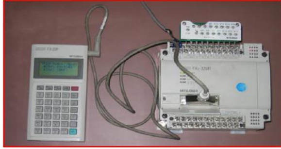
Şekil 4. El tipi programlayıcı ile PLC'nin programlanması (Mitsubishi)
