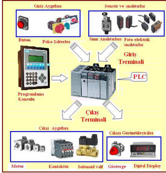
Şekil 2. PLC'nin çalışmasına ait prensip şeması
