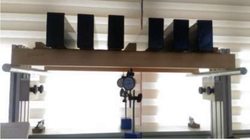
Şekil 2. Dolu gövdeli örneklere yorulma (kalıcı sehime) deneyi
