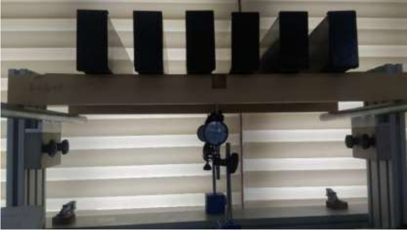
Şekil 3. Kertme gövdeli örneklere yorulma (kalıcı sehime) deneyi
